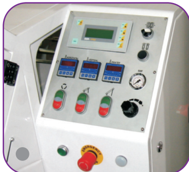
Pannello operatore con comandi remoti
